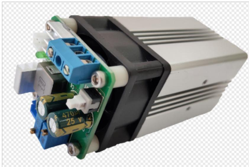
激光雕刻模组激光点焊机高能量的激光脉冲对材料进行微小区域内的局部加热，激光辐射的能量通过热传导向材料的内部扩散，将材料熔化后形成特定熔池。它是一种新型的焊接方式，激光焊接主要针对薄壁材料、精密零件的焊接，可实现点焊、对接焊、叠焊、密封焊等，深宽比高，焊缝宽度小，热影响区小、变形小，焊接速度快，焊缝平整、美观，焊后无需处理或只需简单处理，焊缝质量高，无气孔，可精确控制，聚焦光点小，定位精度高，易实现自动化。
